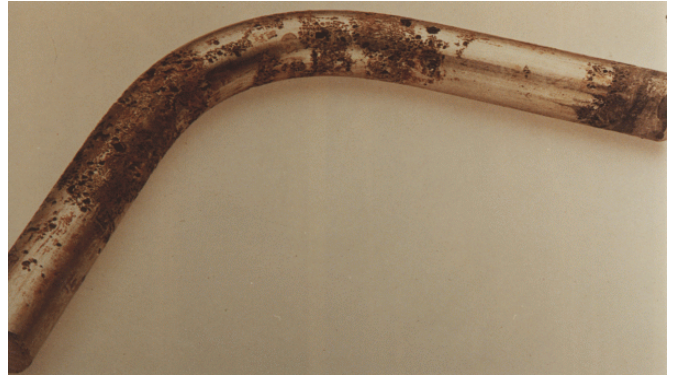
figuur 4.7 Putvormige corrosie
