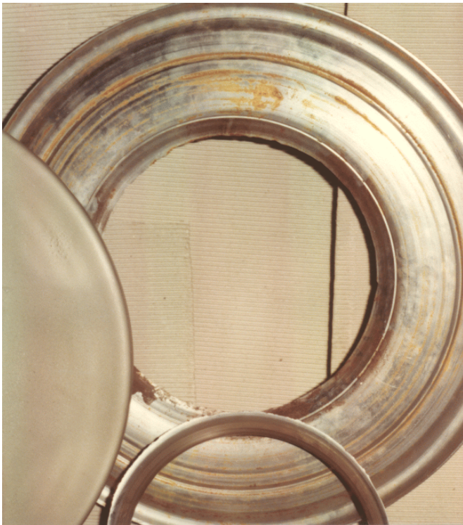
figuur 14.17 Slijtplaat van een centrifugaalpompe
