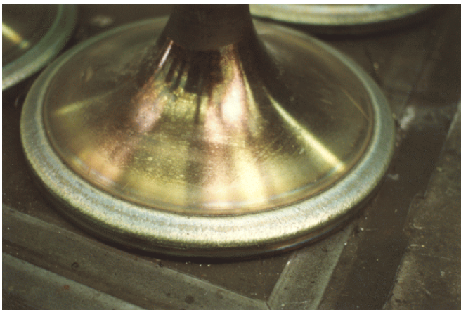
figuur 14.13 Klep van een scheepsmotor
