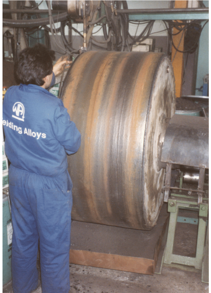
figuur 14.9 Draagrol voor roterende cementmolen
