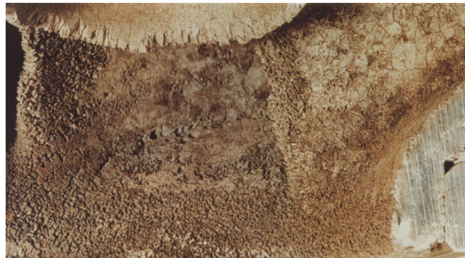
figuur 4.11 Interkristallijne corrosie
