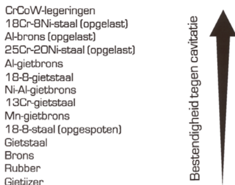
figuur 8.5 Overzicht van een aantal materialen in relatie met bestendigheid tegen cavitatie
