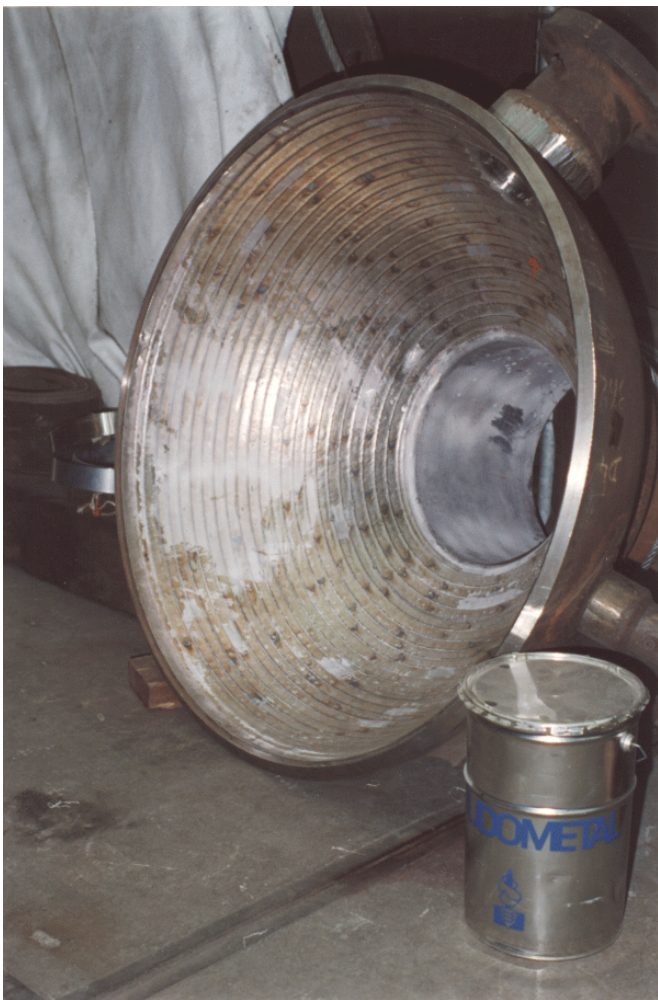
figuur 14.5 Bodem van een drukvat voor de chemische industrie
