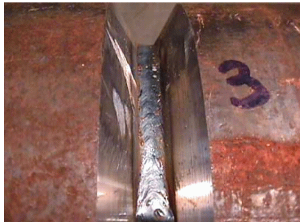
figuur 3.13 Oppervlak van een SST gelaste grondnaad in 15 mm dik pijp materiaal [53]
