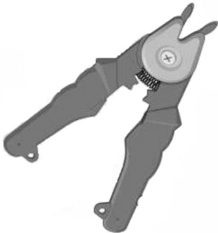
figuur 2.44 Speciale tang voor het afknippen van de lasdraad en het schoonmaken van het gasmondstuk
