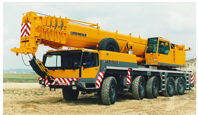
figuur 1.5 Mobiele kraanarm vervaardigd uit staal met hoge sterkte
