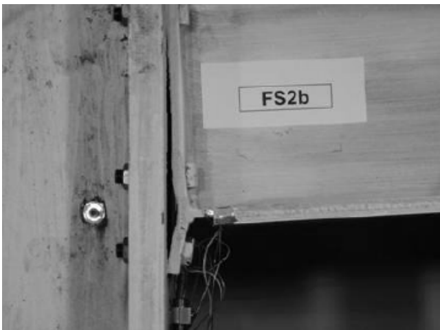
figuur 4.6 Geboute balk-kolom verbinding waarbij door buiging van de kopplaat, de bouten zowel op trek als op buiging worden belast (foto Stevin Laboratorium TU-Delft - onderzoek hoge sterkte staal)
