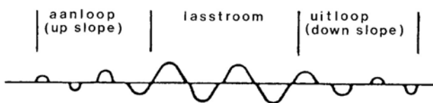
figuur 4.8 Schematische voorstelling van een lasstroom met aanloop- en uitloopregeling
