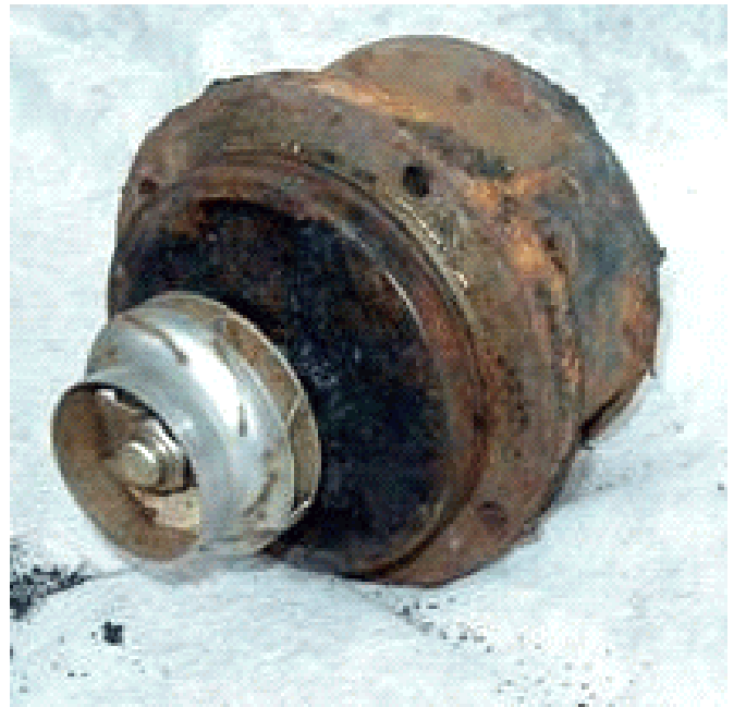
figuur 3.9 Contactcorrosie in een gietijzeren pomphuis met een roestvaststalen waaijer
