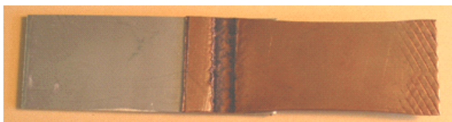
figuur 6.33 AISI 304 verbonden aan koper door middel van explosielassen
