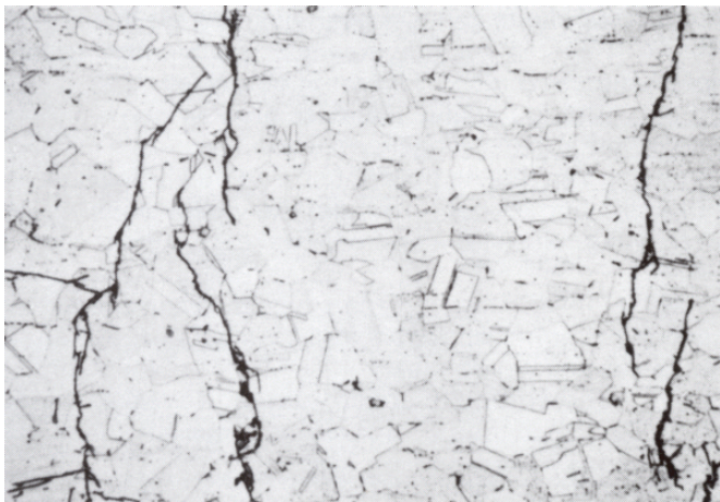
figuur 3.6 Spanningscorrosiescheuren in austenitisch Cr-Ni-staal; scheuren lopen dwars door de kristallieten heen
