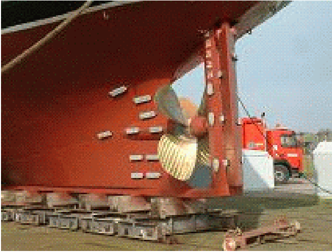
figuur 3.10 Kathodische bescherming van een stalen schip aangedreven door een bronzen schroef door middel van zinkblokken
